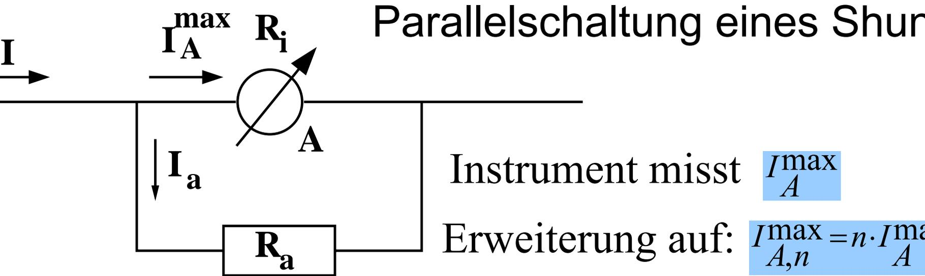
Es muß gelten:  $I = I_A^{\max} + I_a = n \cdot I_A^{\max}$  und  $R_a \cdot I_a = R_i \cdot I_A^{\max}$
