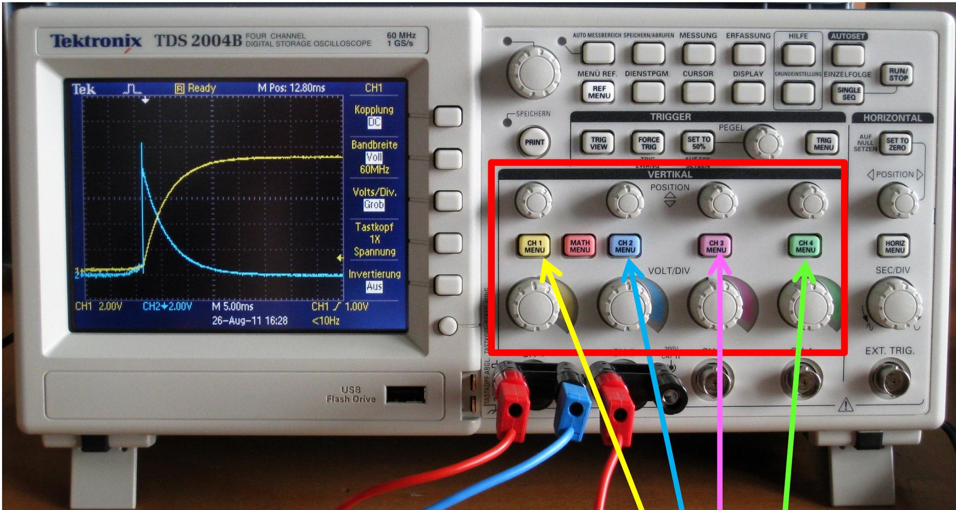
Kanalspezifische Einstellungen: Anzeige der Kanäle 1, 2, 3 und 4 über Druck auf jeweiligen farbigen Schalter
