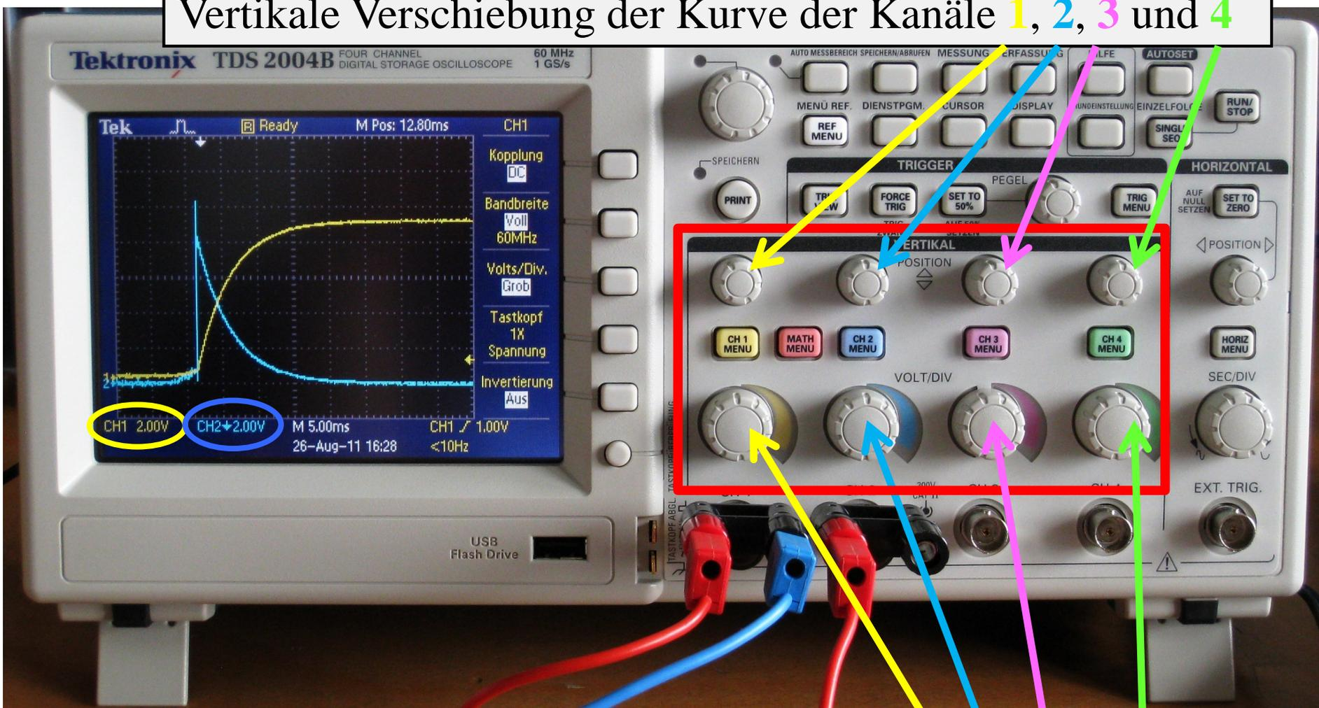
Volt/Div Einstellung der Skalierung der y-Achsen der Kanäle 1, 2, 3 und 4
