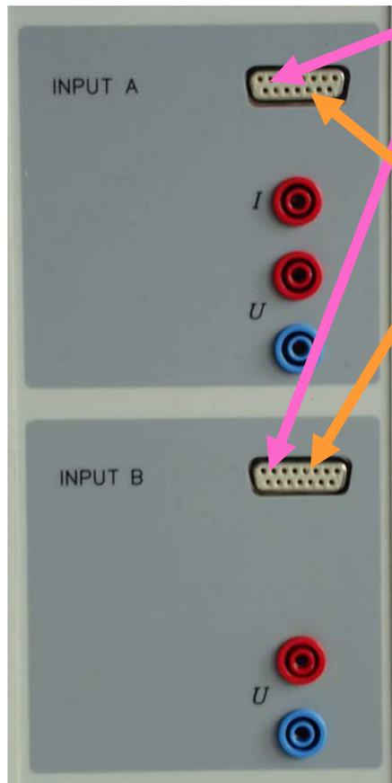
2 analoge Eingänge auf Sensorbox-Steckplätzen A und B
