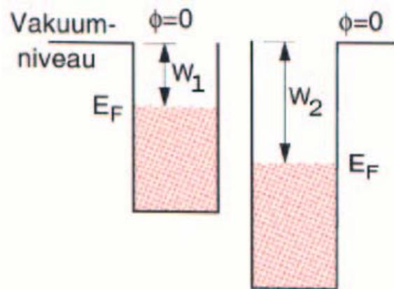
**Seebeckeffekt:** thermoelektrische Erscheinung bei Erwärmung an Grenzfläche zweier verschiedener Leiter (Metalle oder Halbleiter)
