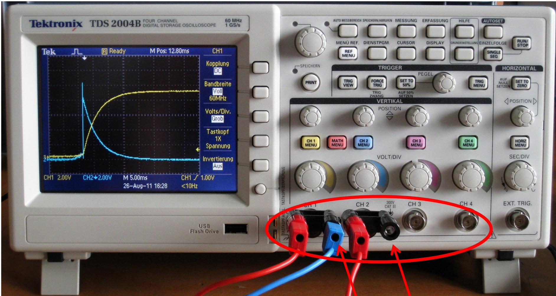
4 Kanal Oszilloskop, die alle die gleiche Masse (Erde) haben
