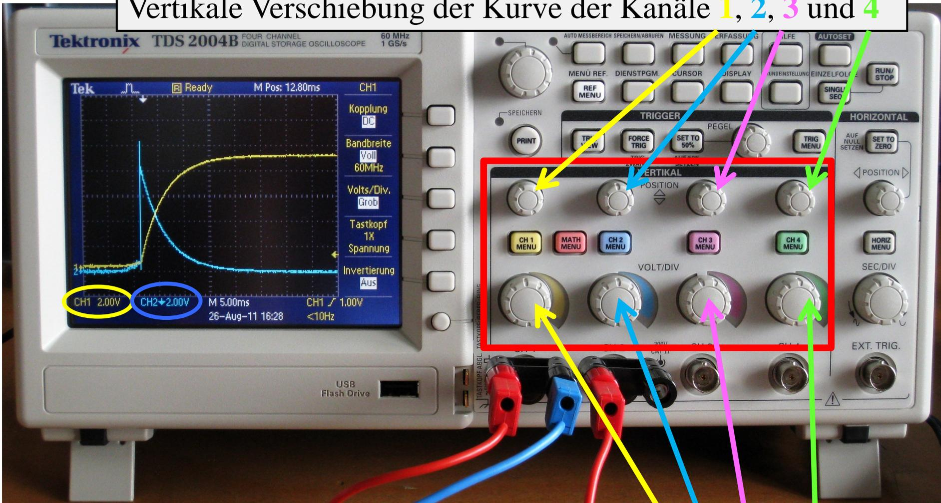
Volt/Div Einstellung der Skalierung der y-Achsen der Kanäle 1, 2, 3 und 4
