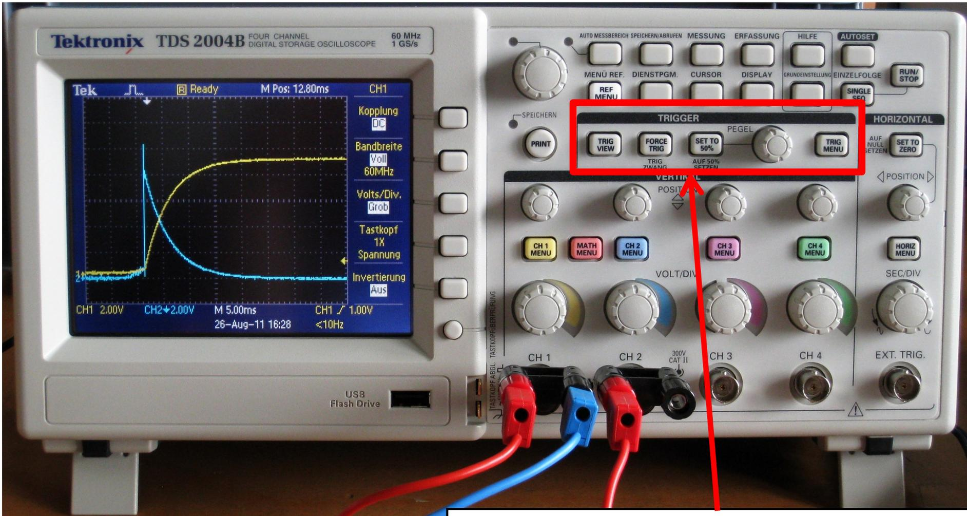
Einstellungen des Triggers, der steuert, wann ein Signal auf Display angezeigt werden soll
