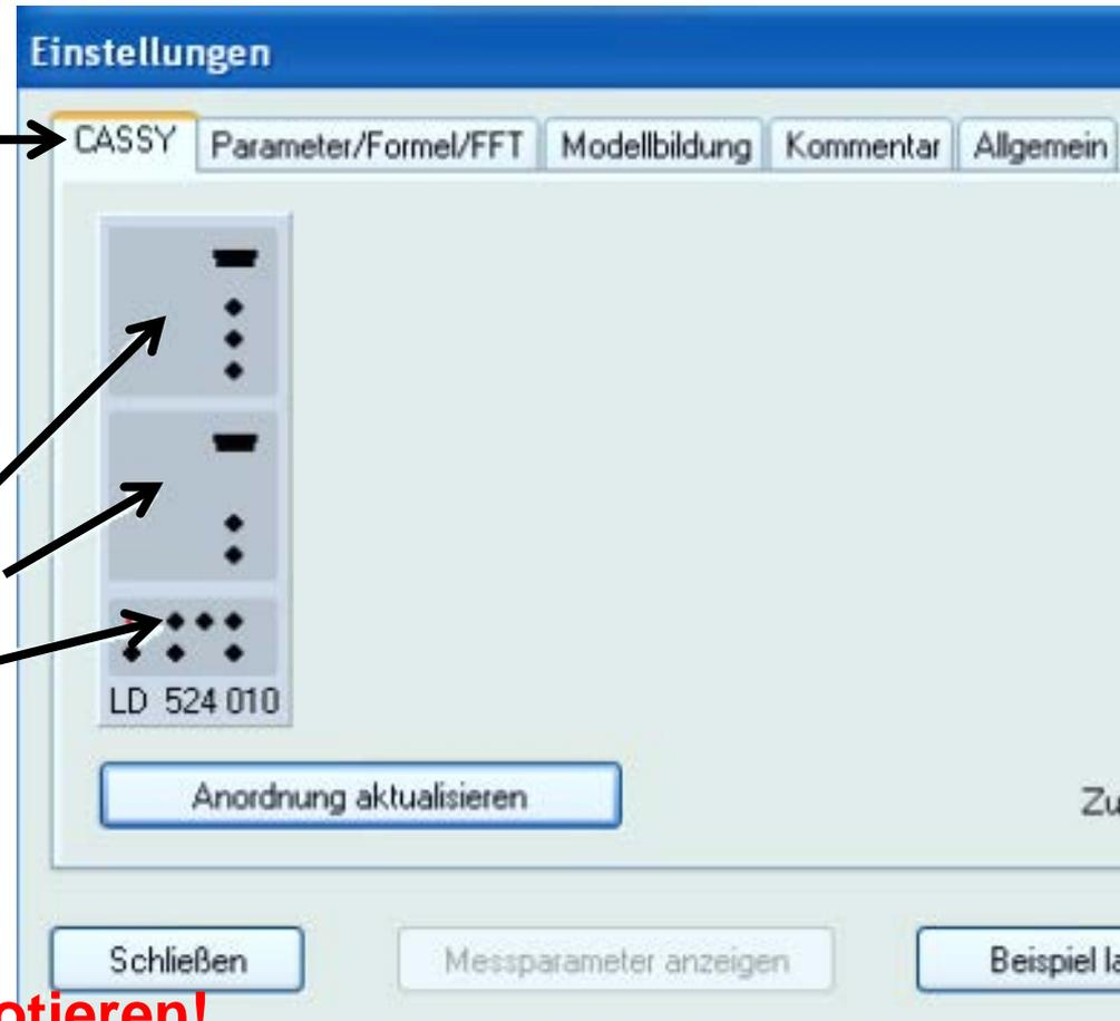
Aktivierung und Einstellung der Eingänge A und B, sowie des Relais und der Spannungsquelle durch Anklicken
