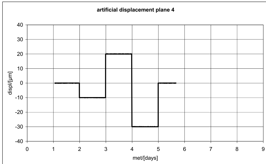
Abbildung 7.18: Künstliche Verschiebung der Ebene 4 vom dritten bis zum fünften Tag der STS-91 Mission, zur Überprüfung des entsprechenden Signals im Cosmic Alignment (getrennt für x und y )
