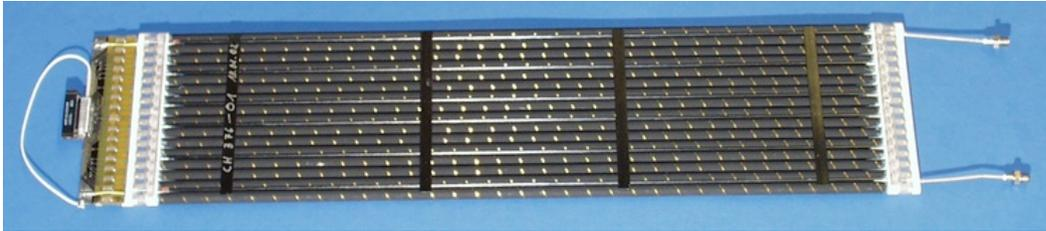
Abbildung 4: *Aufbau eines 376 mm langen Kammermoduls mit 4 Querstreben, die alle 10 cm aufgeklebt werden. Links das UTE-Board mit Steckverbindung zur Auslese der 16 Kanäle und der Hochspannungsversorgung, rechts Gaseinlaß und Gasauslaß.*
