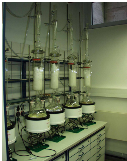
Abbildung 5.5: Soxhlet-Apparatur zur Reinigung des Radiatormaterials [50].
