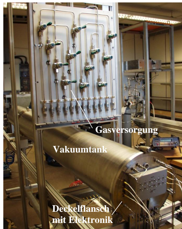
Abbildung 5.15: Serientest: Gasversorgungssystem und Vakuumentank.
