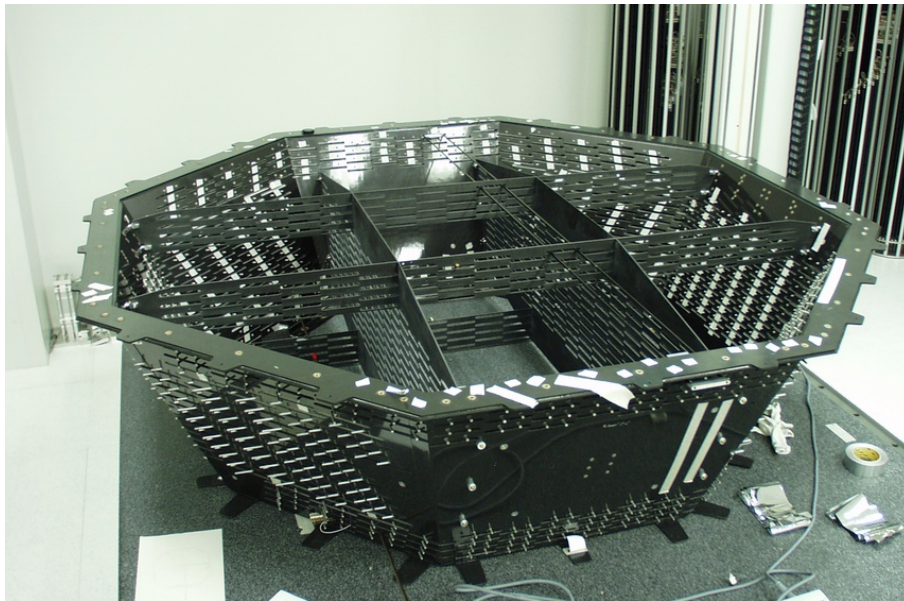
Abbildung 3.16: Foto von der Oktagon-Tragstruktur mit Schottwänden (Stand: Januar 2004).
