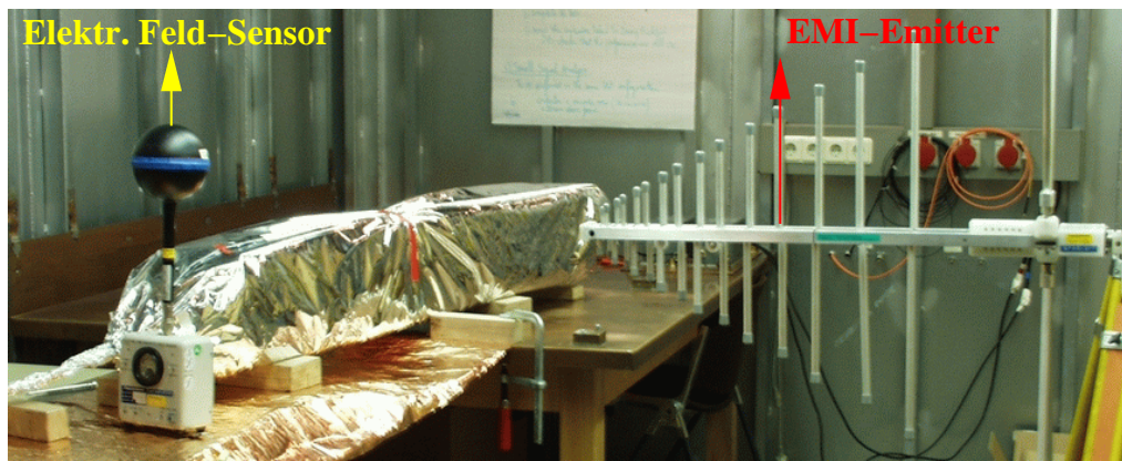
Abbildung 5.3: EMI-Versuchsanordnung bei der Fa. Krauss-Maffei Wegmann AG [84].
