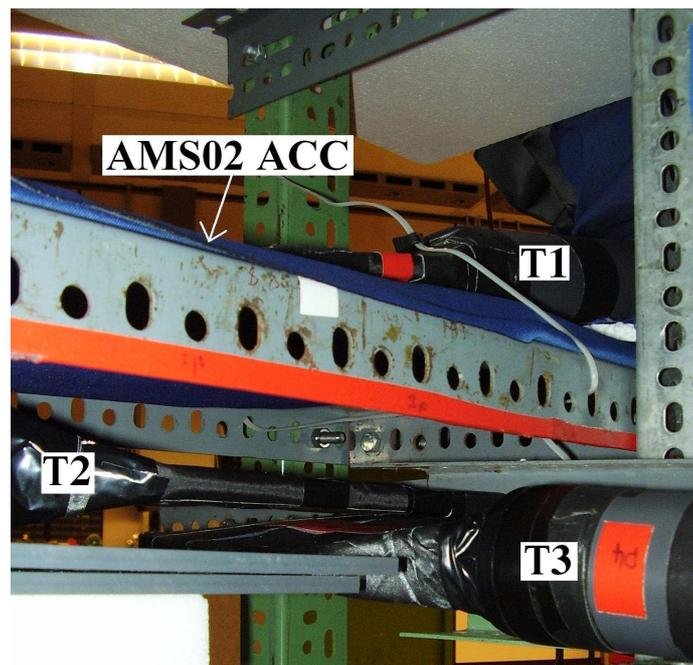
Abbildung 5.12: Aufbau des Trigger zur Untersuchung der ACC Zähler mit Myonen.
