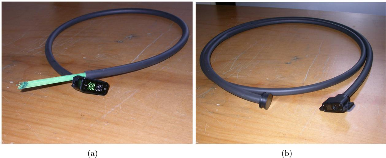
Abbildung 4.34: (a) Photo des Kabels mit 37 WLS - Fasern
